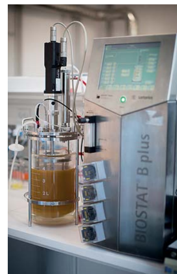
Fermenteringsudstyr på SDU, som netop nu anvendes i et projekt, hvor studerende afprøver en gærstamme. Efter leverandørens oplysninger har gærstammen potentiale til at gære op til et alkoholindhold på 25%, og den slags udsagn er svært at lade ligge uprøvet for Bent Lyager og hans studerende. Foto: Anders Boe
